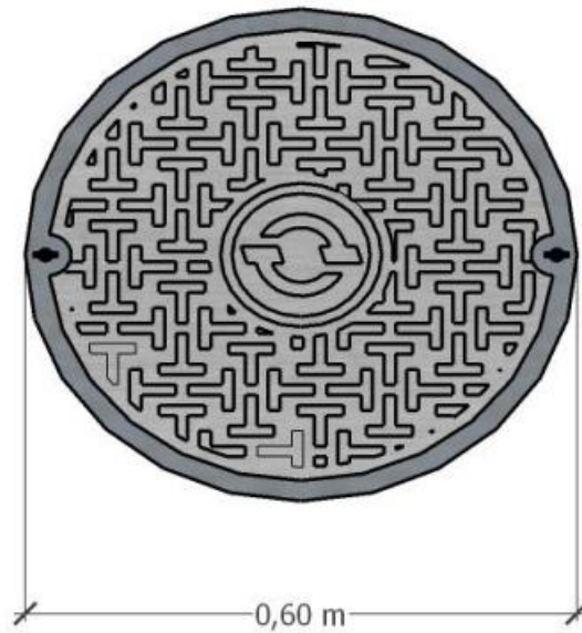
Gambar 6-24 Detail Bak Kontrol
